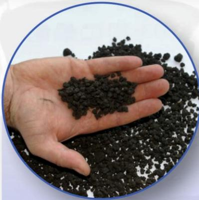
Während der Faulschlamm vor seiner Entwässerung einen Feststoffanteil von nur ca. 3 % aufweist, ist dieser danach mit durchschnittlich 28 % deutlich trockener. Auf dem Bild links ist die Konsistenz des entwässerten Schlammes zu sehen.
